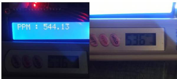
Pada pengujian keempat hasil pengukuran terhadap larutan campuran antara air bersih, nutrisi A dan nutrisi B dari TDS meter dan alat yang dibuat penulis memiliki sedikit selisih yang terdapat antara pengukuran menggunakan TDS meter dan alat yang dibuat, berbeda halnya dengan pengujian pertama dan kedua, pada pengujian keempat terdapat selisih sebesar 8 ppm. Pada alat yang dibuat terbaca 544 ppm sedangkan pada TDS meter terbaca 536 ppm.
