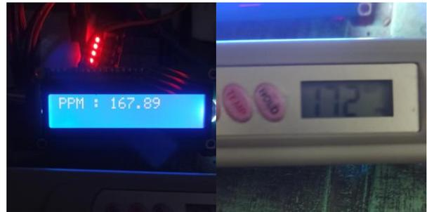
pada pengujian pertama dilakukan pengukuran terhadap air bersih, dimana pada pengujian pertama hanya memiliki sedikit selisih yang terdapat antara pengukuran menggunakan TDS meter dan alat yang dibuat, yaitu hanya 5 ppm. Pada alat yang dibuat terbaca 167 ppm sedangkan pada TDS meter terbaca 172 ppm.
